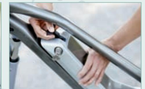
Sowohl die Unterrohr-Akkus als auch die im Gepäckträger integrierten Akkus lassen sich einfach und bequem abnehmen – sind aber absperbar und so effektiv gegen Diebstahl gesichert!
