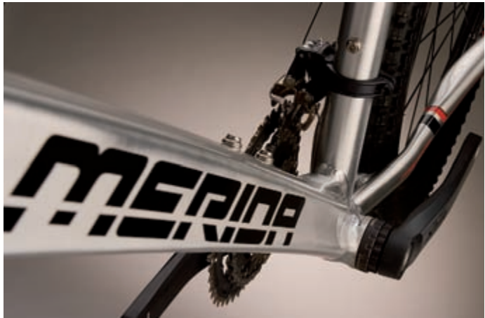
Die konkaven (nach innen eingezogenen) Seitenflächen des MATTS HFS Unterrohrs sind ein Novum bei Alu-Rahmen und können nur durch das HFS-Verfahren der neuesten Generation realisieren.
