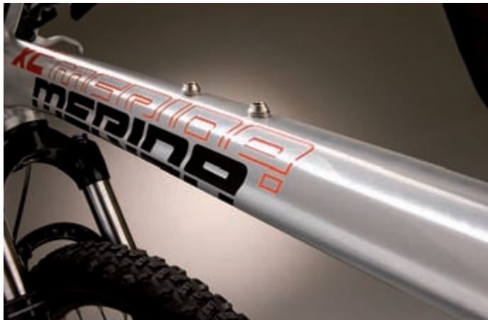
Mechanisch in Form gebracht: Dank langjährigem Know-how kann MERIDA Racelite 6061 Rohre mittels TFS in attraktive und belastbare Rohr-Querschnitte umformen.
