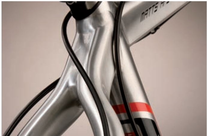
Aus einem Fluss: Der Monostay des MATTS HFS XC Pro-Rahmens führt die Linie des Oberrohrs harmonisch in die Sitzstreben über.
