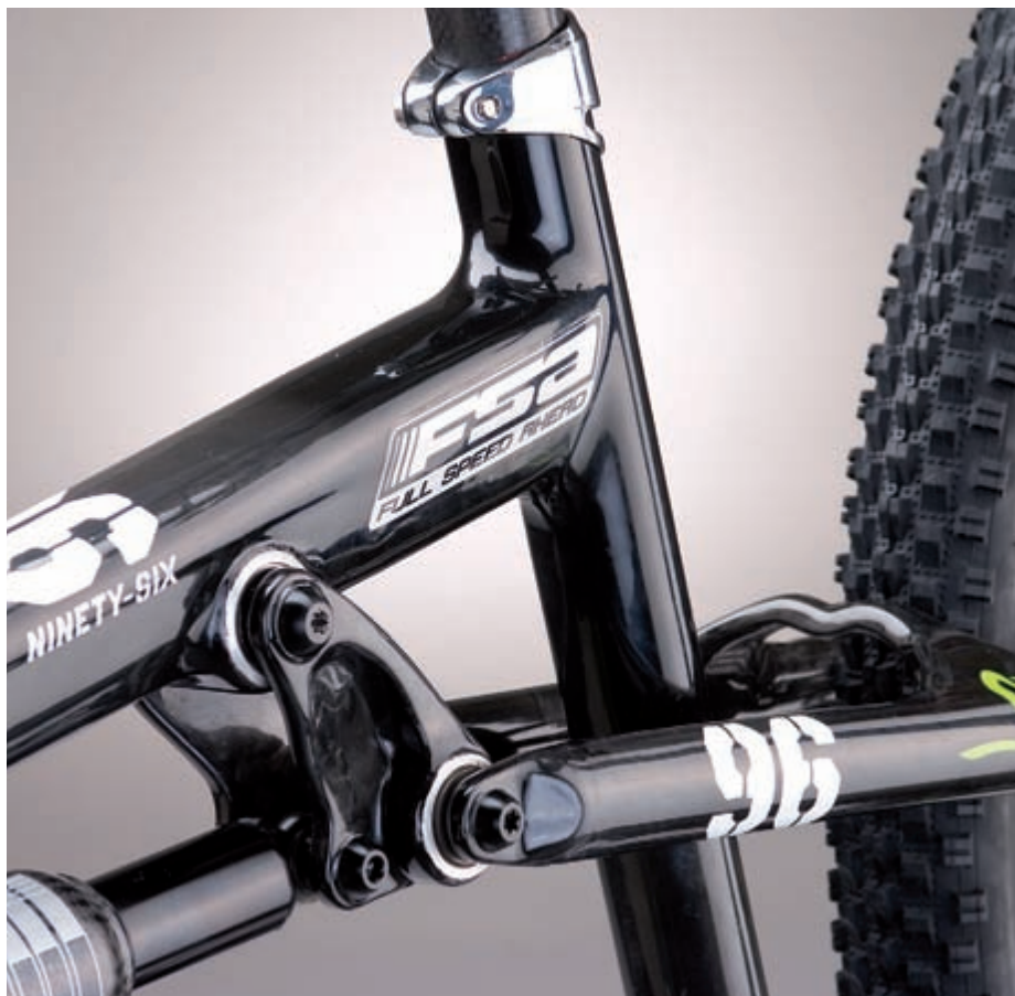
Alles Kohle: Neben dem Ninety-Six Rahmen ist auch die Dämpfer-Wippe komplett aus Carbon gefertigt.
