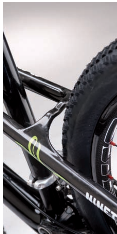
Zwischen den Sitzstreben sorgt ein organisch geformter Quersteg für zusätzliche Torsionssteifigkeit.
