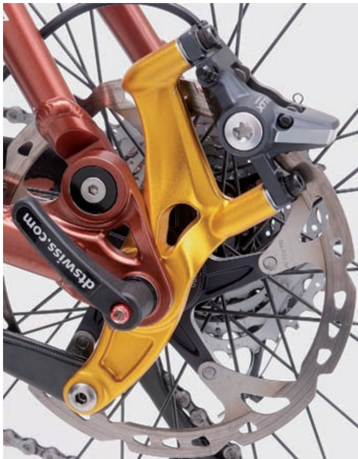
FLOATING DISC isoliert die hintere Bremse vollständig von der Federung. Das Bremsmoment wird über eine Carbon-Zugstrebe direkt in den Hauptrahmen eingeleitet.
