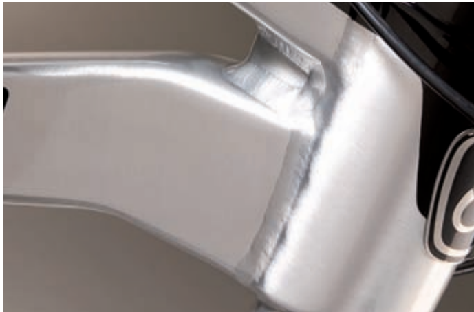
Schön und belastbar: Das HFS Steuerrohr mit den jeweils perfekt anschließenden Ober- und Unterrohr greift das MERIDA Design der Carbon-Linie auch bei Alu-Rahmen auf.
