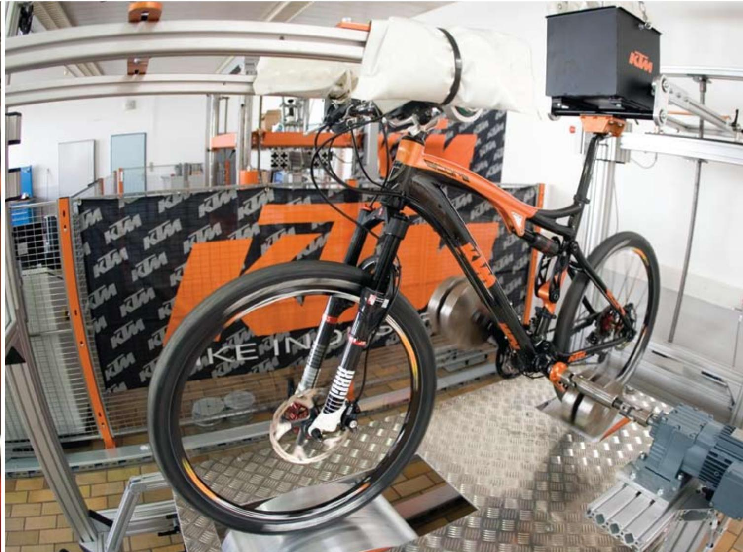
**Brandneue Testeinrichtungen** sorgen für die höchste Qualität. Ein komplettes Fahrradleben kann in 70 Stunden simuliert und getestet werden. Deshalb erhöht KTM die Garantie für Alurahmen ab sofort auf 5 Jahre und für Carbon-Rahmen auf 3 Jahre.
